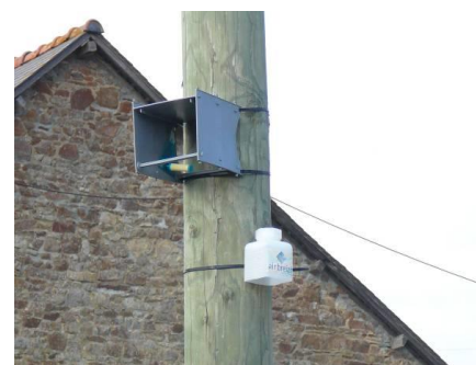
Figure 3 : Tube à diffusion passive sous abri
