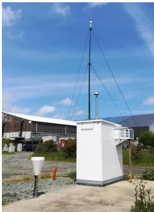
Figure 2 : Station de mesure installée sur le site de Lantic avec mât météorologique et pluviomètre.
