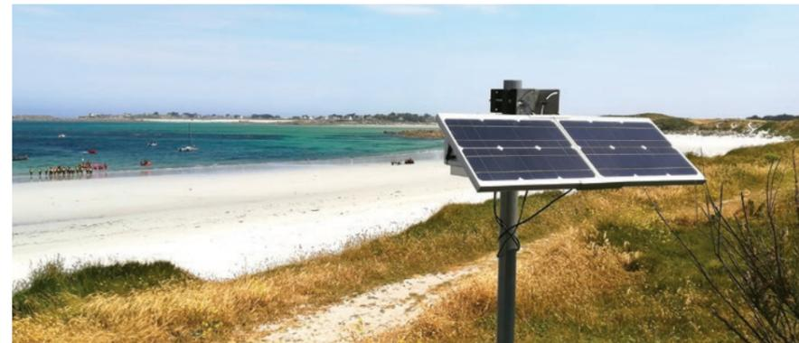
Capteur H<sub>2</sub>S sur l'un des points de mesure
