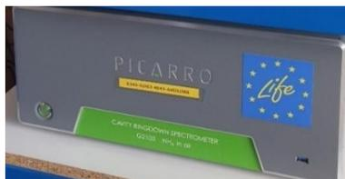
Figure 2 : Analyseur de mesure du  $\text{NH}_3$  en continu installé à Rocabey
